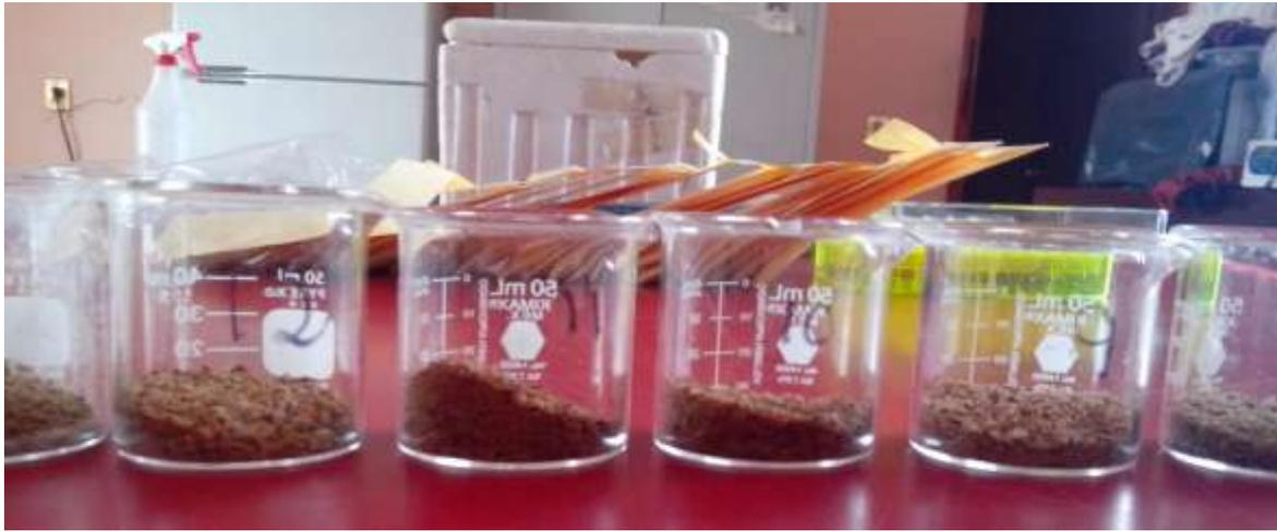
Figura 16. Muestras con metanol al 70%, se agregaron 12.5 ml de metanol y se agito manualmente durante 3 min
