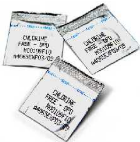
Figura 3. Reactivo marca “Hach” para determinación de cloro total
