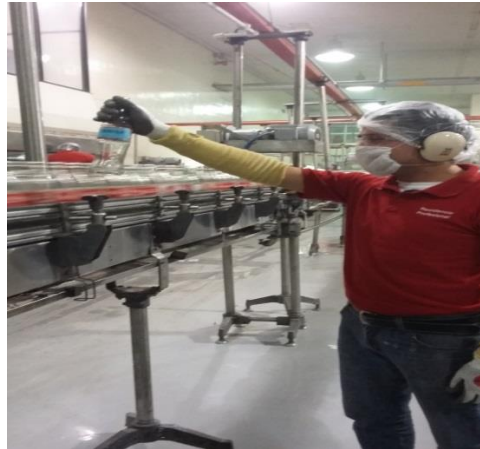
Imagen 8.8 Colocación de la botella señuelo en la banda transportadora
