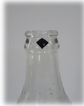
Figura 8.1. Imagen del señuelo suciedad opaca del acabo.
