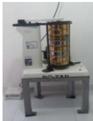
Ilustración 27. Zaranda y medidor portátil de Temperatura y Humedad para Maíz
