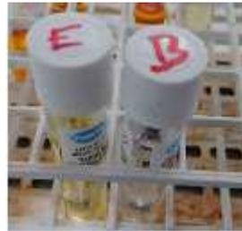
Se toman dos viales ácidos. Se toman 2ml de B colocarla en uno de los viales nuevo y agitar, repetir para E. presionar enter y reposar 5 min.
