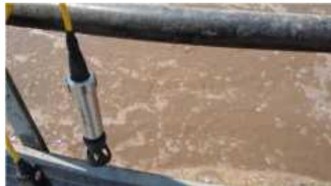
Se coloca la sonda dentro de los reactores (50 cm aprox.) y se analiza.
