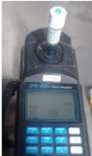
Colocar B (rojo) en el lector HACH y presionar zero.
