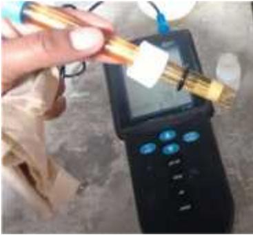
Se prende el equipo HACH y se retira la sonda del buffer para limpiarla.
