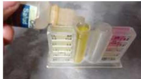
Se colocan 5 gotas del indicador ortho tolidina hidrocioruro, y se agita. Se toma nota del vire de color.
