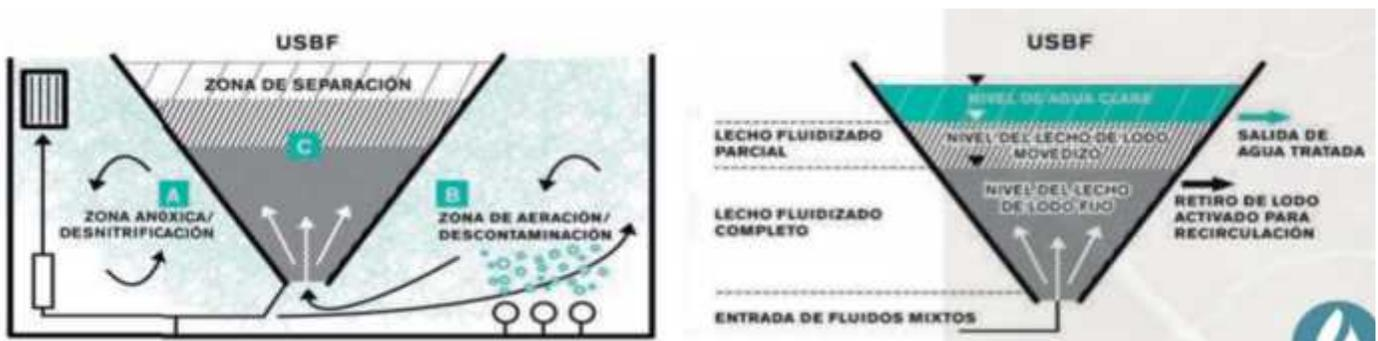
Figura 4. Mecanismo del sistema USBF
