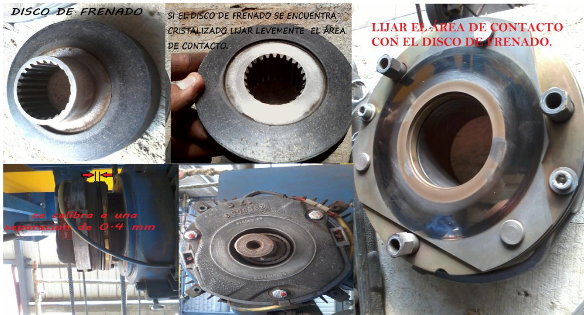
Fig. 35 Disco de frenado, balata y su calibración.
