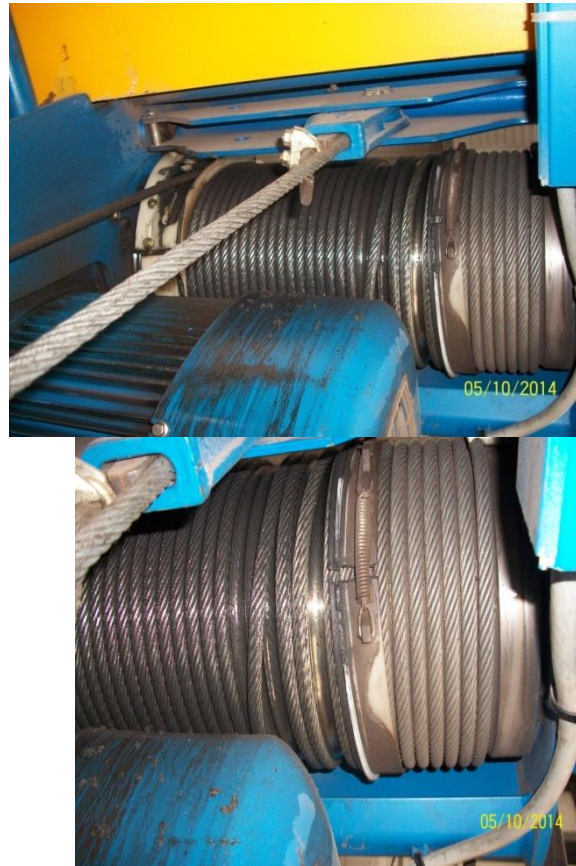
Fig. 30- Mala colocacion del cable en la guía.
