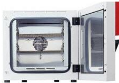
Figura 9: Estufa Binder, utilizada para determinación de humedad.
