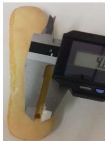
Figura 16: Medición de perforación con ayuda de un Vernier
