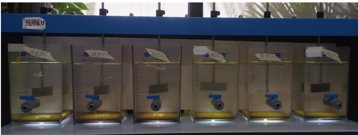
Figura 9. Apariencia de las Jarras en la prueba para obtener el pH óptimo de operación después del periodo de sedimentación.
