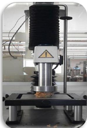
Figura 3.10 Medición de la textura de los tamales.
