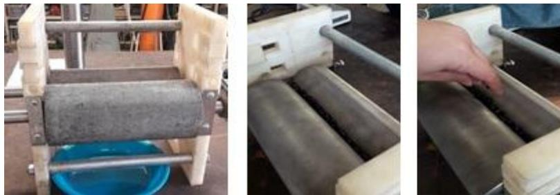
Figura 3.3 Proceso de descascarillado con prototipo
