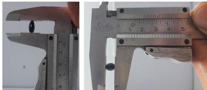
**Figura 3.2** Determinación de diámetros mediante Vernier
