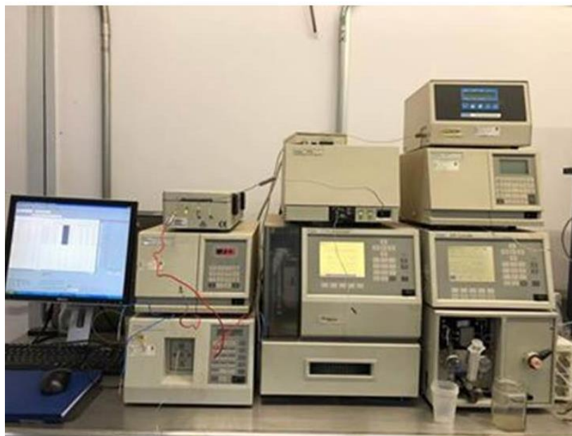
Figura 8. Cromatógrafo para la cuantificación del ácido clorogénico.
