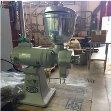
Figura 6. Molino de discos Maren 1.5HP, Pulvex. Figura 7. Tamizador RX-29, RO TAP.
