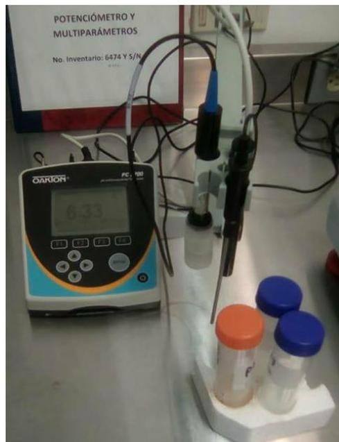
Figura 4. Potenciómetro
