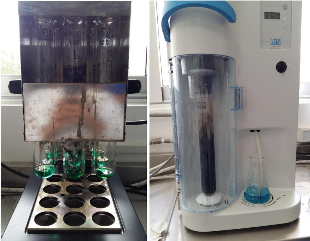
Figura 9. Unidad de digestión y destilación
