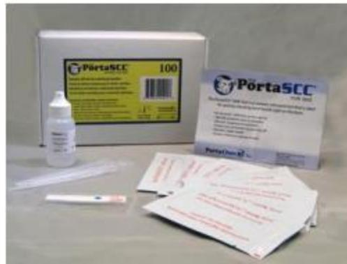
Figura 2. Equipo para realizar la prueba de conteo de células somáticas
