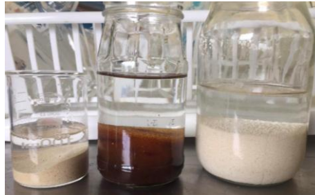
Figura 8. 11. Arena y resinas hidratadas con agua desionizada.
