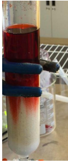
Figura 8. 16. Lecho de resina aniónica con muestra 4.
