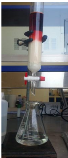
Figura 8. 18. Efluente tratado con resina aniónica.
