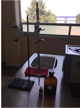
Figura 8. 6. Equipo volumétrico para la determinación de cloruros.
