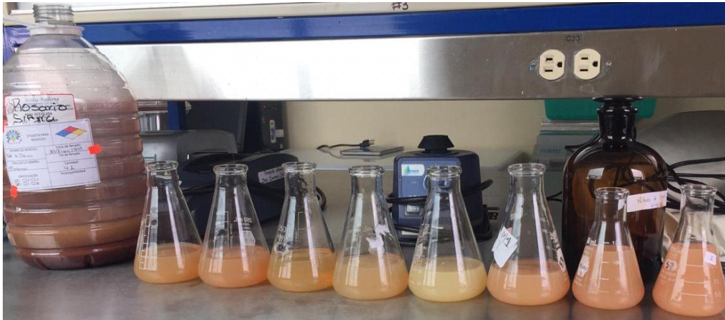
Figura 8. 7. Determinación de cloruros a partir de la NMX-AA-073-SCFI-2001.
