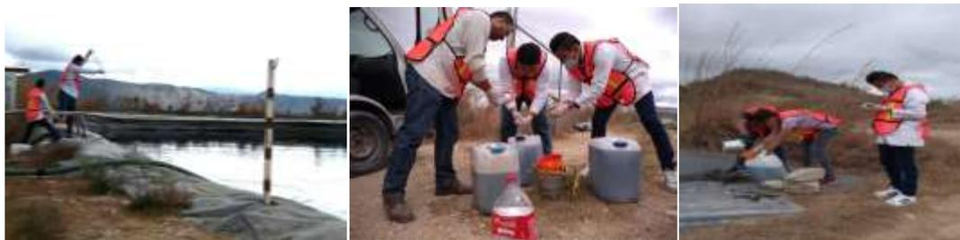
Figura. 7 recolección de los lixiviados en la laguna en el sitio de disposición final de Tuxtla Gutiérrez
