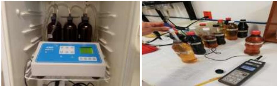
Figura. 9 prueba de análisis para DBO (demanda bioquímica de oxígeno).
