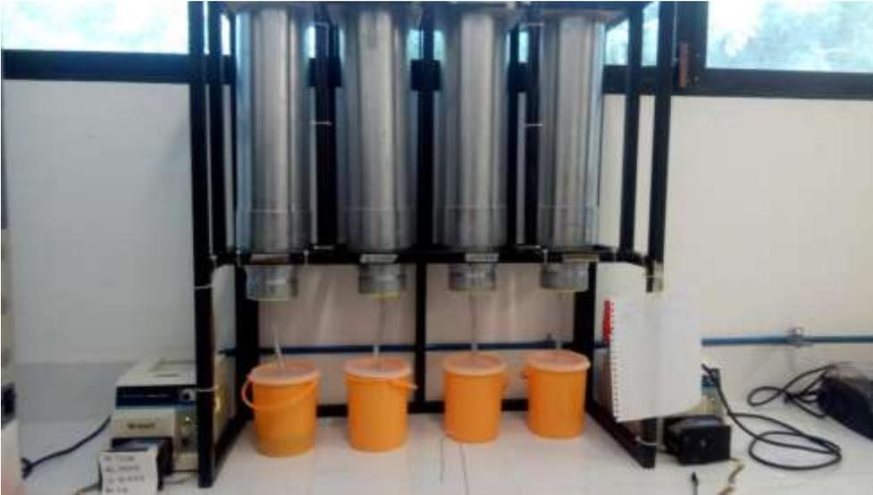
**Figura. 4** biorreactor semi-aerobo.
