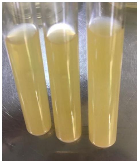
Figura 6. Tubos positivos de la prueba de coliformes fecales en caldo Ec, obtenidos en el análisis del agua.
