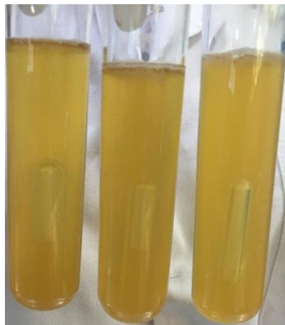
Figura 4. Tubos positivos de la prueba presuntiva de coliformes en caldo lauril sulfato de sodio, obtenidos en el análisis del agua.
