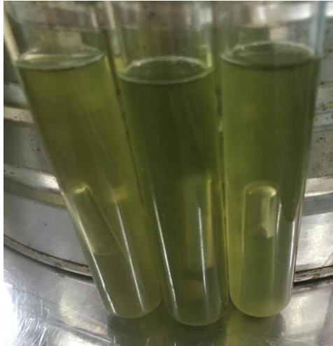
Figura 5. Tubos positivos de la prueba presuntiva de coliformes totales en caldo bilis verde brillante, obtenidos en el análisis del agua.
