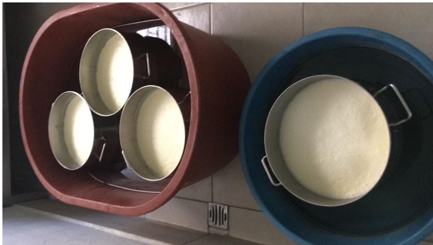
Figura 3.1. Método usado por la industria para enfriar la leche, utilizando agua de la llave.
