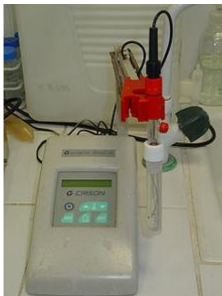
Figura 1. Potenciómetro o pH-metro utilizado para medir el pH de una disolución.
