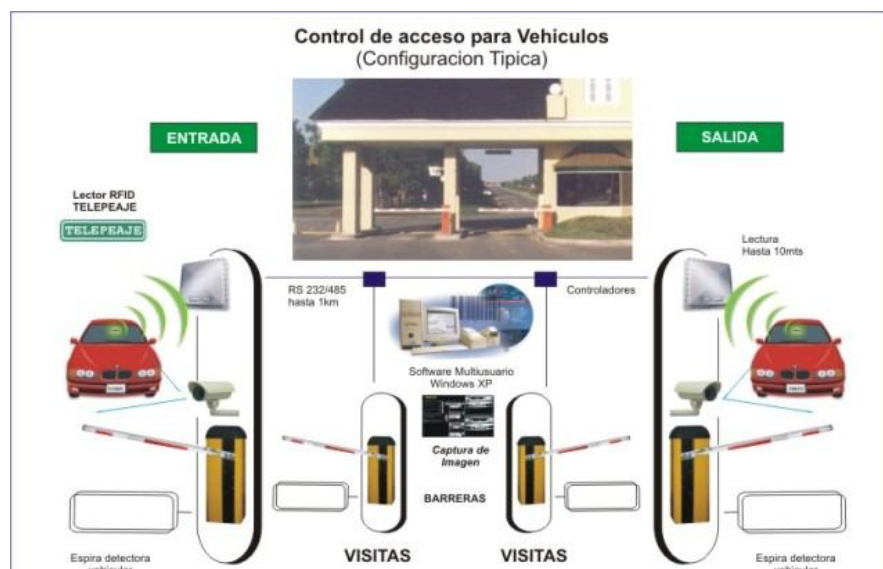
Figura 2 Control de Acceso para Vehículos del Sistema Sicpass
