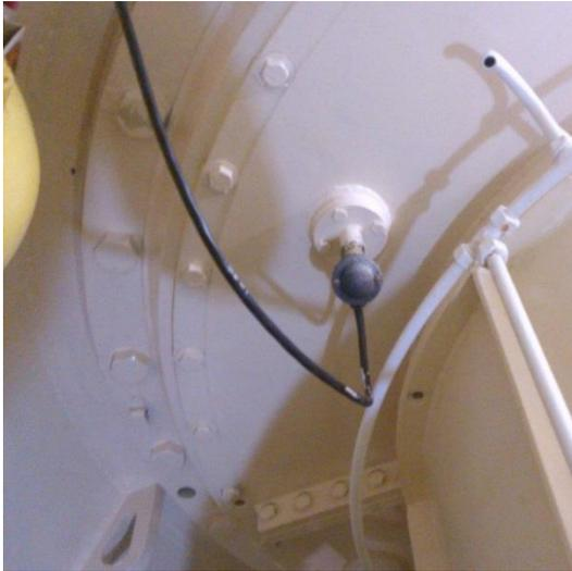
**Figura 3.2** Sensores de temperatura a resistencia en el metal de la chumacera para el registrador de temperatura
