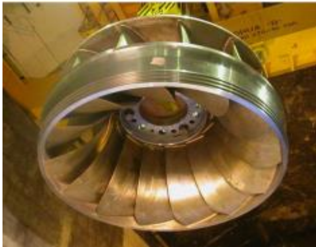
Figura 2.4. Fotografía de un rodete de una turbina Francis.
