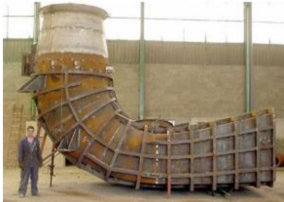
Figura 2.5. Fotografía de un tubo de aspiración.
