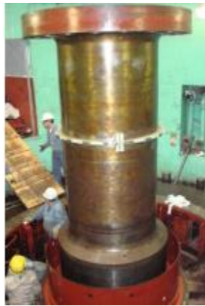
Figura 2.6. Fotografía de una flecha para turbina Francis.
