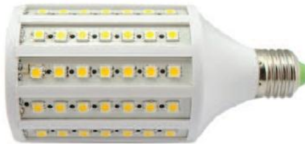
Fig.2.17. Por definición un LED SMD es un diodo emisor de luz de montaje en superficie, este tipo de LED está encapsulado (solo o junto a más LEDs) en una resina semirígida y dispuesto sobre un circuito impreso.
