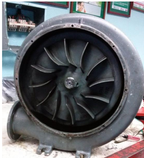
Fig. 7.26 Turbina del extractor de vapor.
