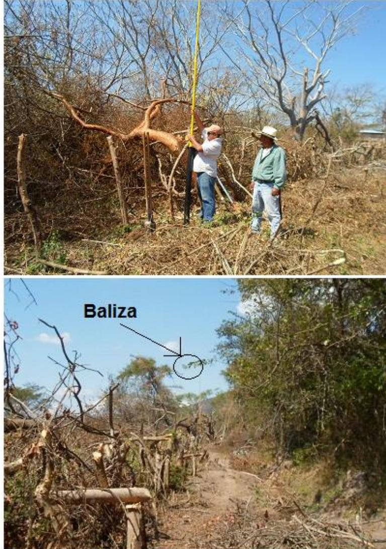
**Figura 3.3. Trazo de línea con baliza.**
