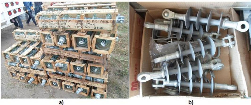
**Figura 3.12. a) Aislador 6SV, b) Aislador 13SHL45C**
