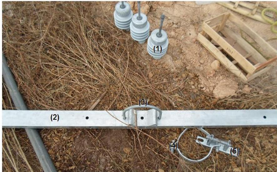
Figura 3.6. Herrajes de la estructura TS3N
