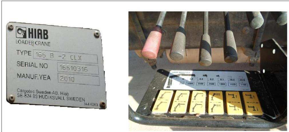
**Figura 2.29. Placa de datos y controles de mando de la Grúa..**
