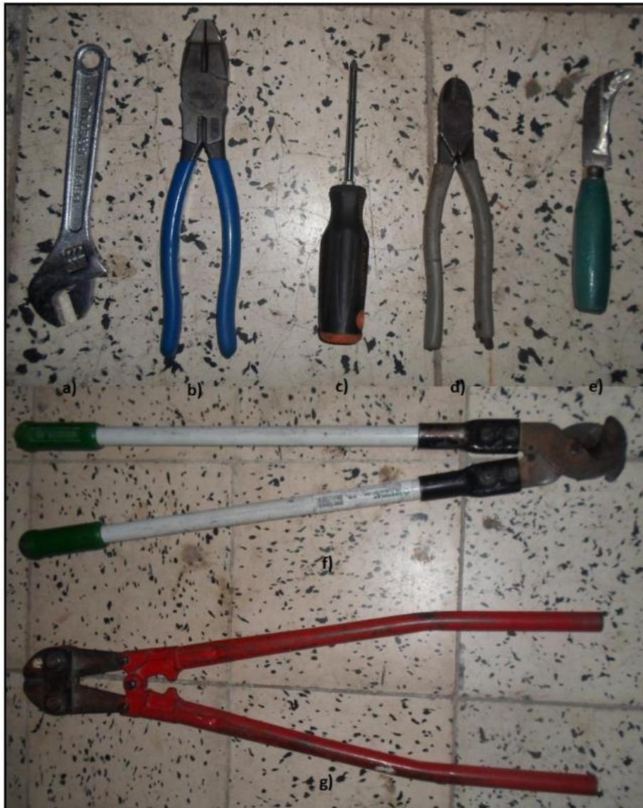
**Figura 2. 30. a) Perica, b) Pinza electricista, c) Desarmador de cruz, d) Pinza de corte, e) Navaja pelacables de liniero, f) cizalla para cortar cable, g) cizalla para cortar retenida.**
