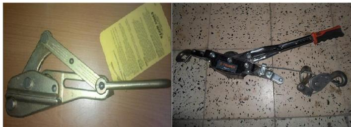
**Figura 3.27. Herramientas para el tensado de conductor**
