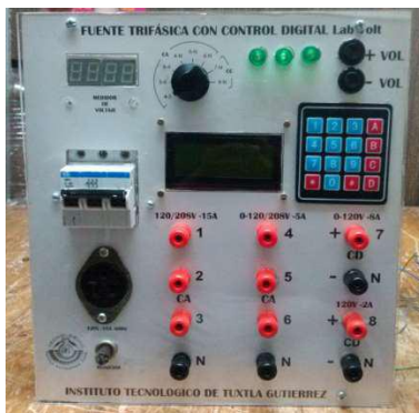
Fig. 1.1 Fuente trifásica digital actual.
