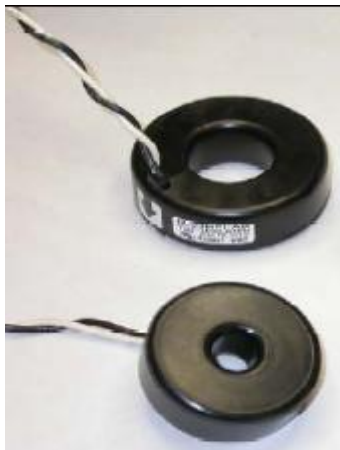
Fig.3.54. Los CT de núcleo sólido son más precisos por un menor costo
