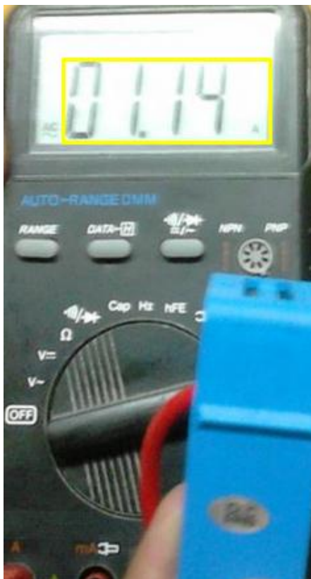
Fig. 5.6. Medición de corriente con un multímetro.
