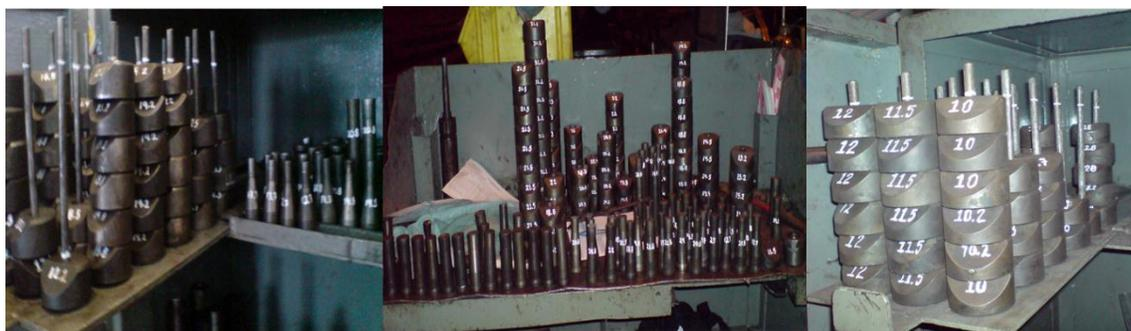
**Figura 5.5** Evidencia de identificación y colocación del herramental
