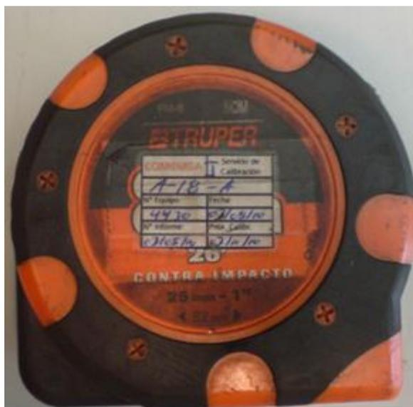
**Figura 4.4** Etiqueta de Equipo de medición
