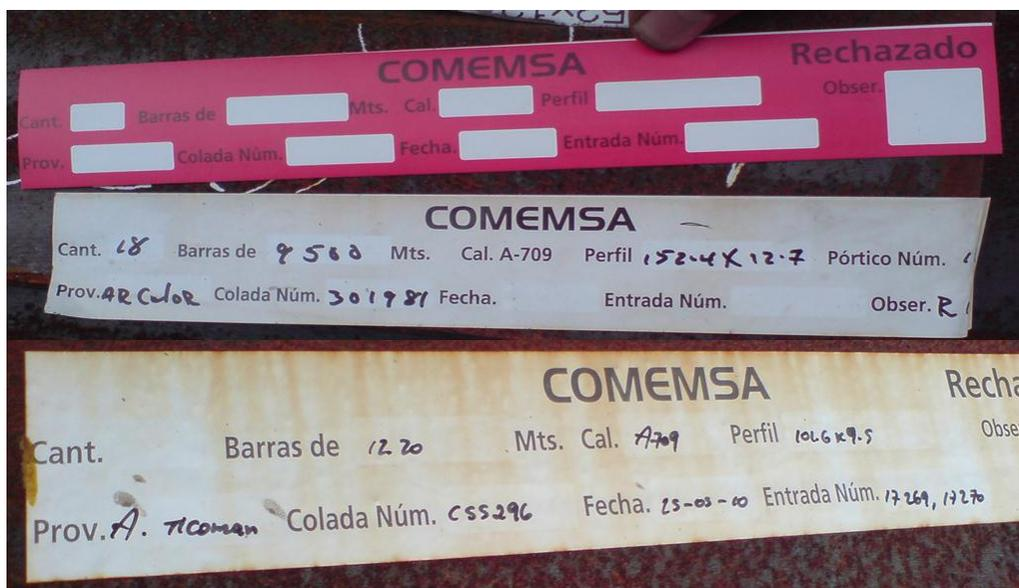
**Figura 4.11** Etiquetas decoloradas de material rechazado y aceptado
