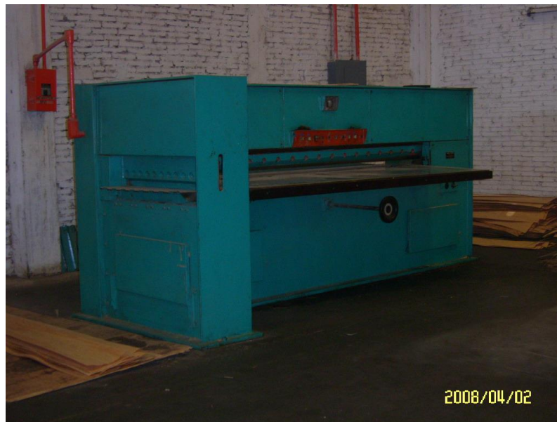
Figura 2.12 Cortadora SAVI (Fuente: Industrial Maderera y del Triplay, S. A. de C. V.)
