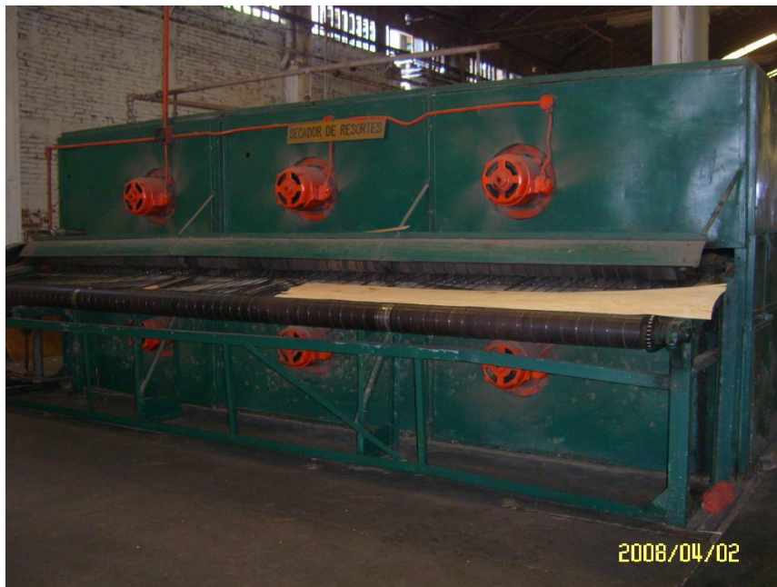
Figura 2.9 Alimentación de Secador de Resortes (Fuente: Industrial Maderera y del Triplay, S. A. de C. V.)
