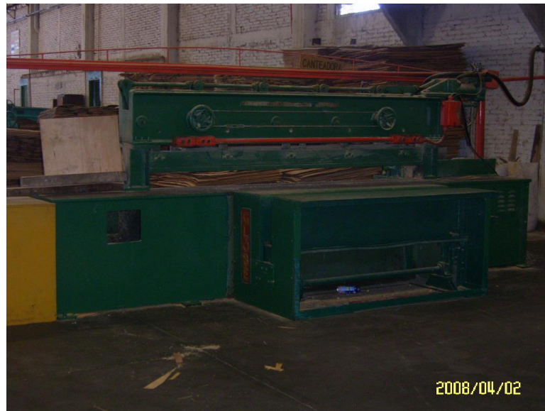
Figura 2.13 Canteadora Alimentación y Salida (Fuente: Industrial Maderera y del Triplay, S. A. de C. V.)
