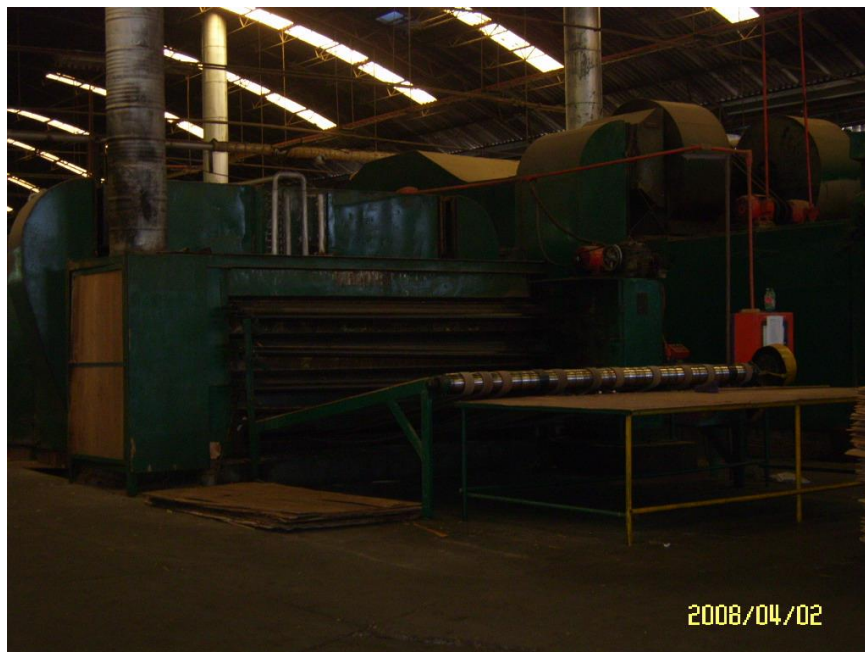
Figura 2.8 Salida de Secador de Vistas (Fuente: Industrial Maderera y del Triplay, S. A. de C. V.)
