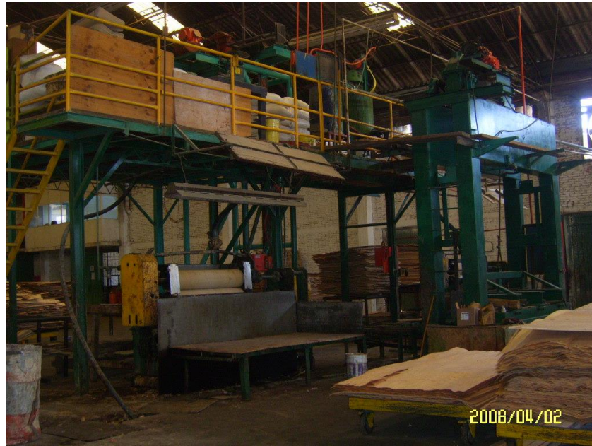
Figura 2.18 Engomadora y Torre de Preparación de Goma (Fuente: Industrial Maderera y del Triplay, S. A. de C. V.)
