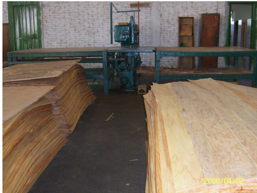
Figura 2.17 Parchadora (Fuente: Industrial Maderera y del Triplay, S. A. de C. V.)
