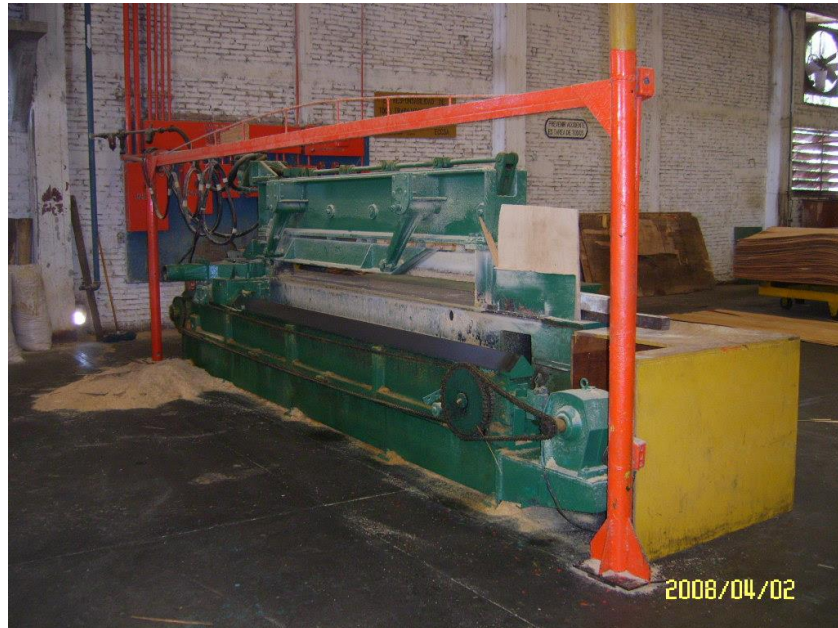
Figura 2.14 Cantadora Salida de Desechos (Fuente: Industrial Maderera y del Triplay, S. A. de C. V.)
