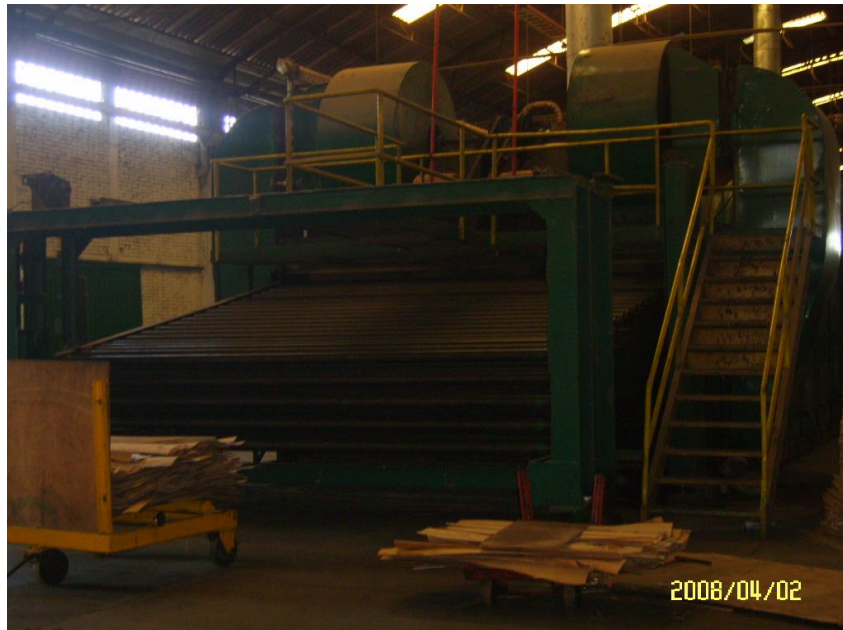
Figura 2.5 Alimentación de Secador de Centros (Fuente: Industrial Maderera y del Triplay, S. A. de C. V.)
