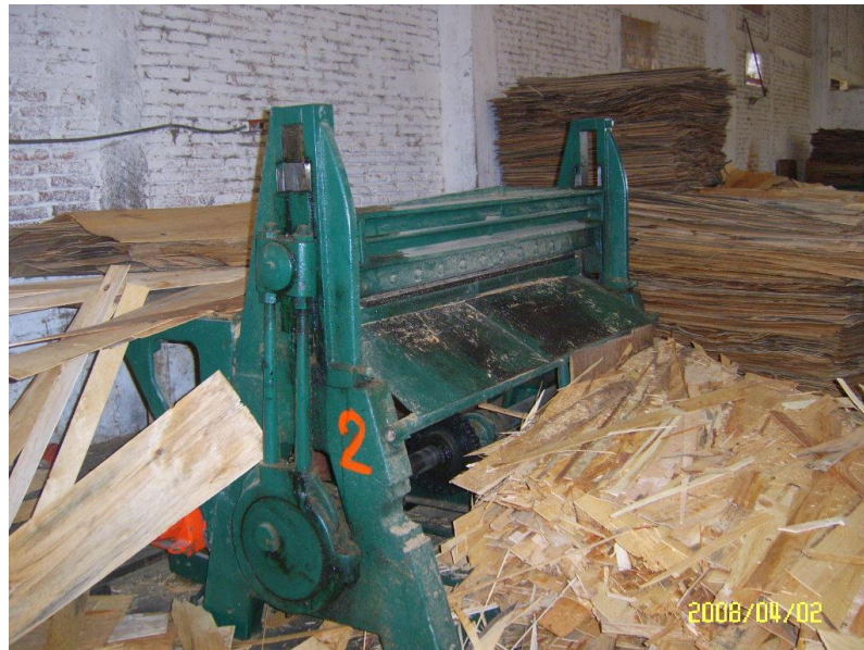
Figura 2.11 Guillotina (Fuente: Industrial Maderera y del Triplay, S. A. de C. V.)
