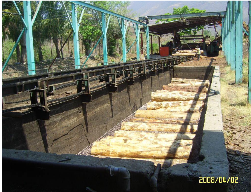
Figura 2.13 Estanques Grandes de Humectación Retira la Trementina de la Troza Mediante el Uso de Agua y Vapor (Fuente: Archivos de Producción)
