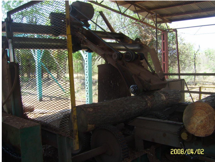
Figura 2.11 Área de Descortezadora, Desprende la Corteza de las Trozas (Fuente: Archivos de Producción)
