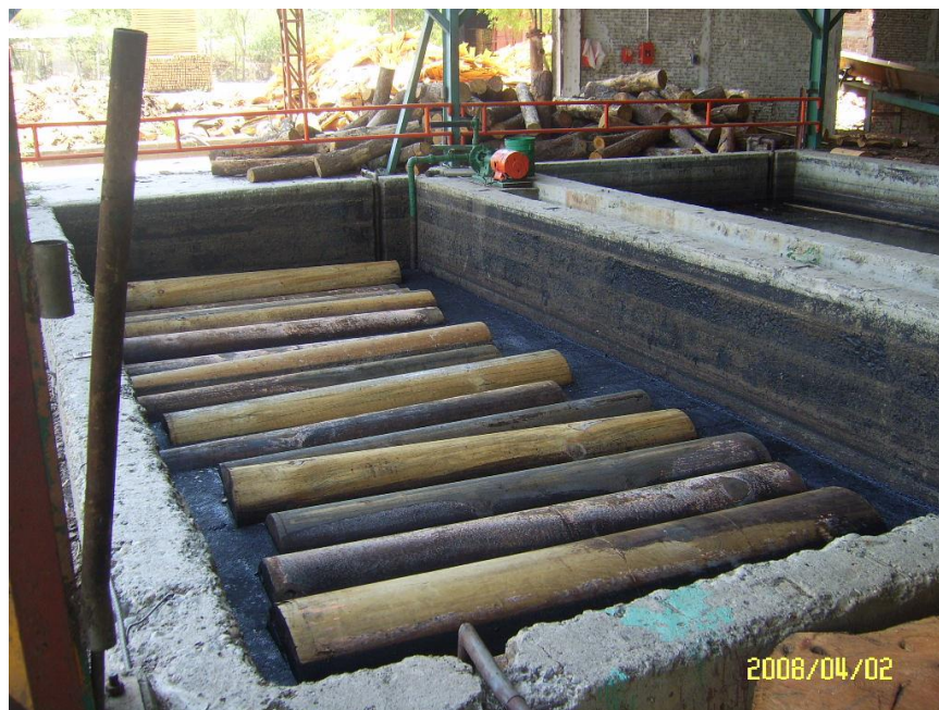
Figura 2.14 Estanques Chicos de Humectación Retira la Trementina de la Troza Mediante el Uso de Agua y Vapor (Fuente: Archivos de Producción)
