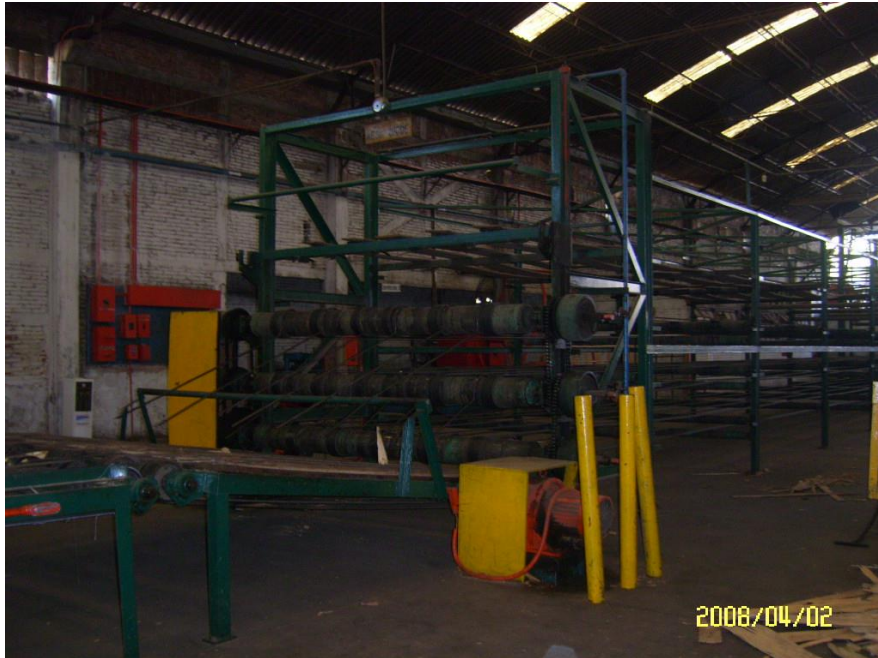
Figura 2.19 Bandas Transportadoras Tiple, Transportan las Trozas al Área de Mesa Verde. (Fuente: Archivos de Producción)
