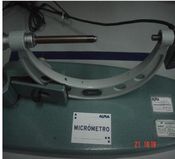
**Fotografías C-3** Micrómetro para medir espesores.
