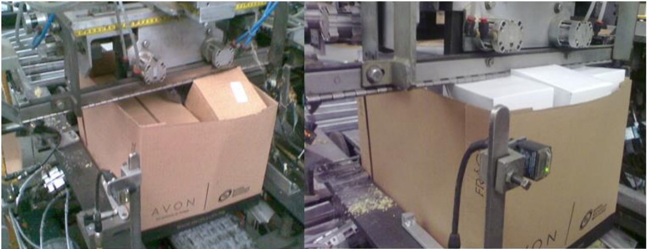
Fig. 3-3. Mal acomodo de producto ocasionando un paro en la maquina.
