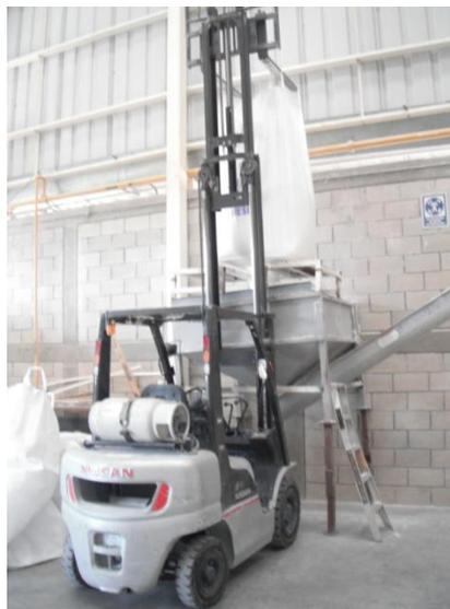
Imagen 5.2.- Montacargas colocando Costal de Resina en Llenadora de Tolva
