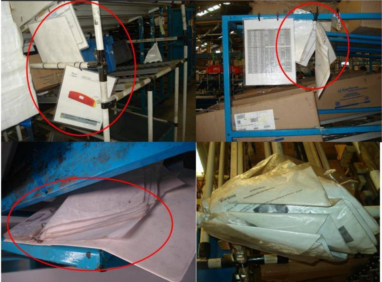
Fig. 4.4 Documentación en mal estado
