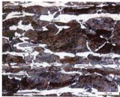
Foto 6, pieza 1 Microestructura en corte longitudinal. 500:1 Nital 3%
