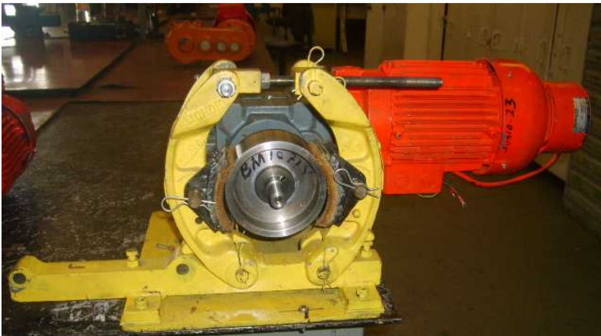
Figura 5.11. Dispositivo de Prueba para reductores Bauer (Fuente: Información obtenida)
