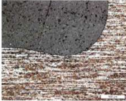
Foto 4, pieza 1 Microestructura en corte longitudinal. 16:1 Nital 3%
