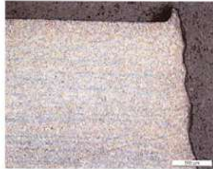
Foto 5, pieza 2 Microestructura en corte longitudinal. 16:1 Nital 3%
