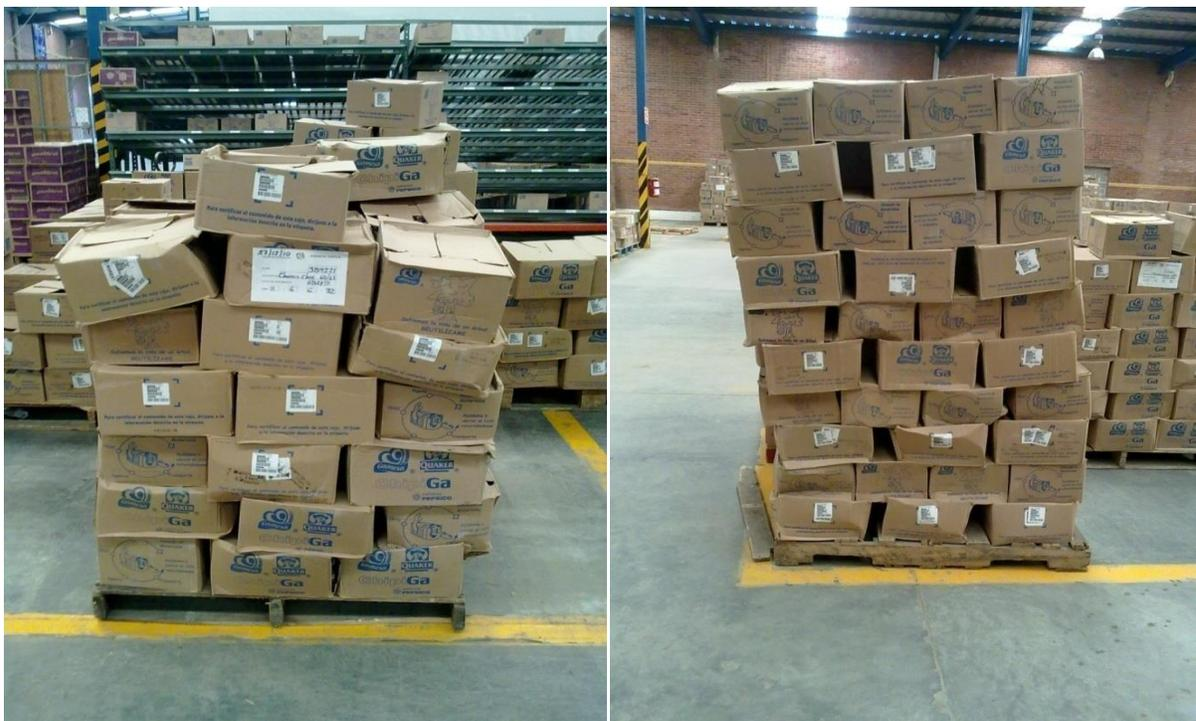
**Figura 4.23** Condiciones de maltrato y daños a la mercancía por una inadecuada estibación
