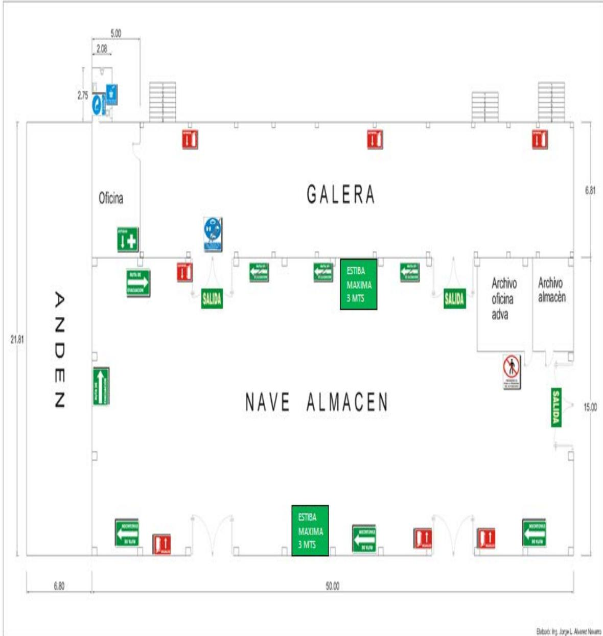
**Figura 6.1.1.8** Señales de Seguridad en el Almacén General
