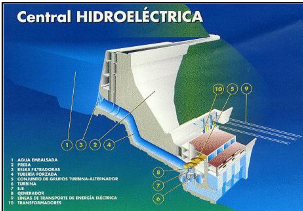
**Figura 2.2.1** Componentes de una Central Hidroeléctrica
