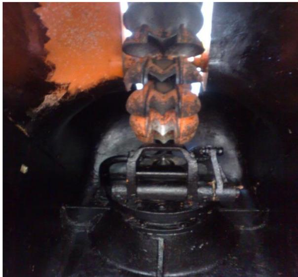
Figura No. 16. Apreciación de los cangilones del rodete de la turbina.
