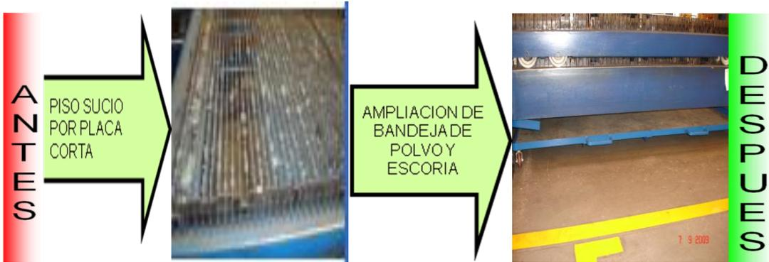
**Figura 6.14.** Fuente de contaminación del piso
