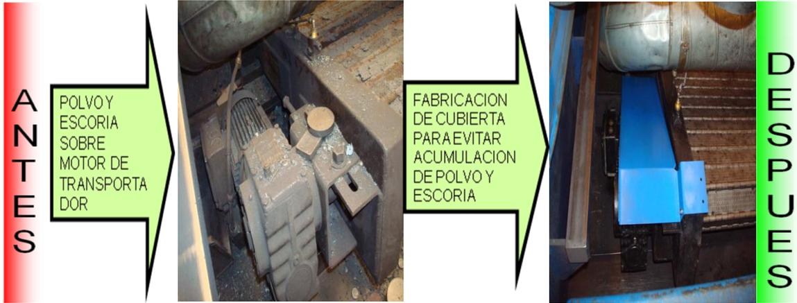
**Figura 6.13.** Contramedida para acumulación de escoria en motor eléctrico
