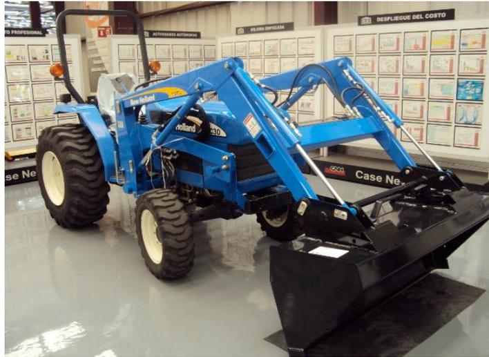
**Figura 2.10.** Tractor New Holland con Front End Loader
