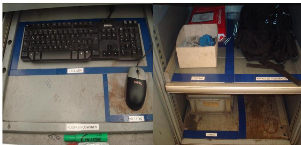
**Figura 6.3.** Aplicación de 5 S's en gabinete de equipo de computo
