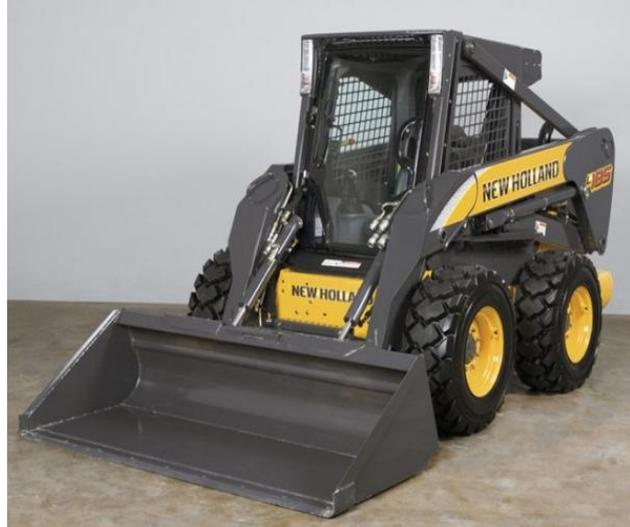
**Figura 2.8.** Mini cargador New Holland
