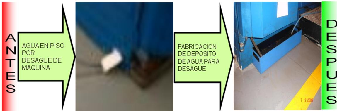
**Figura 6.15.** Fuga de agua ensuciaba el piso
