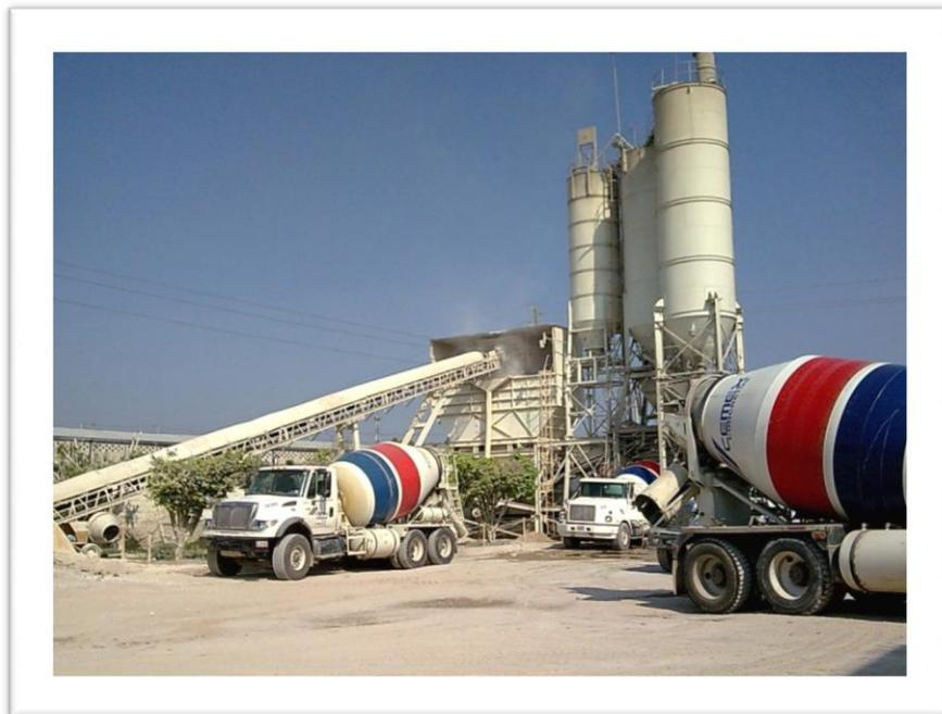
**Figura A2. Bascula y planta dosificadora**
