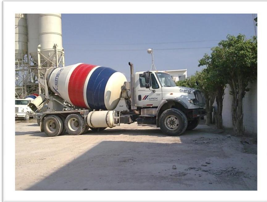
Figura A3. Camión revolvedor o CR
