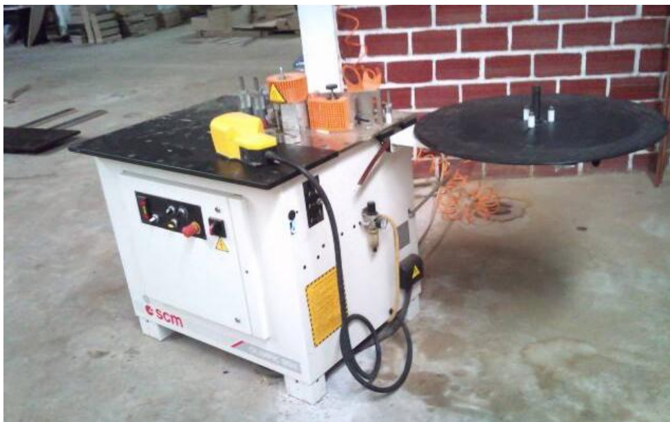
Fotografía 7.3 Estación de trabajo No. 4 Enchapadora Olimpik M90.
