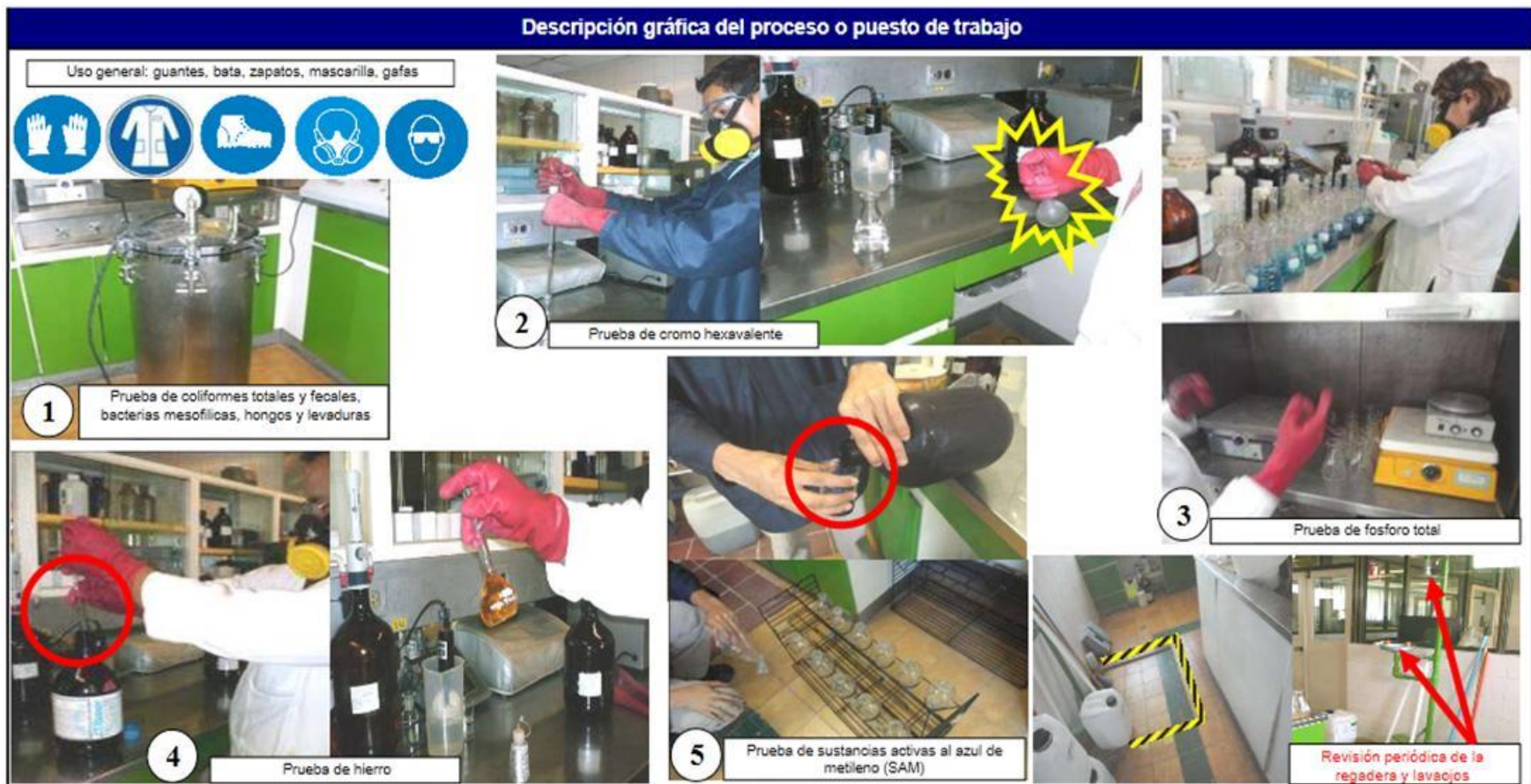
Figura 5.28 Evidencia gráfica ARMEO previo Nave 38H – Pruebas espectrofotométricas y microbiológicas
