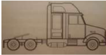
Figura 3.11 vehículo de 3 ejes Tracto camión (Fuente: Díaz de santos, Manual del transportista 2002: 57).
