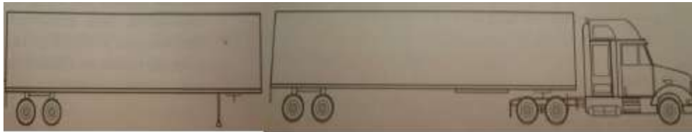
Figura 3.15 Vehículo con eje 7 ejes, armado con un semi-remolque y un remolque. (Fuente: Díaz de Santos, Manual del transportista 2002: 59).
