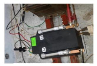
Figura.3.9 Transformador de potencial
