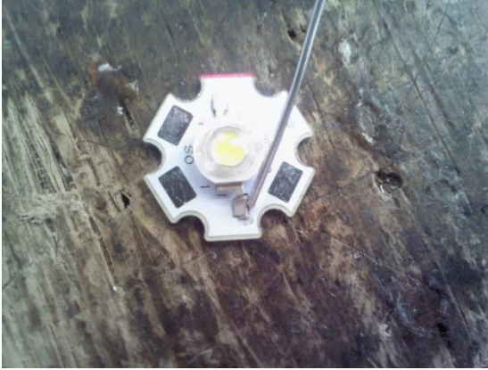
Figura 5.21 Posicionamiento de Estaño (Fuente: Elaboración Propia)
