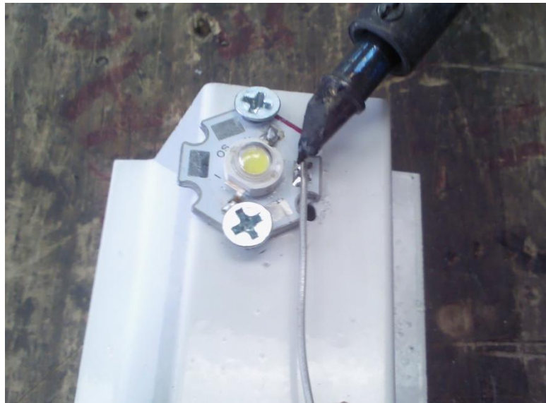
Figura 5.12 Posicionamiento de Cautín (Fuente: Elaboración Propia)
