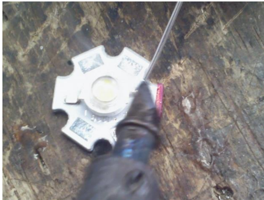
Figura 5.22 Estañado de Pestaña de LED (Fuente: Elaboración Propia)
