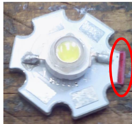
Figura 5.25 LED con franja roja (Fuente: Elaboración Propia)
