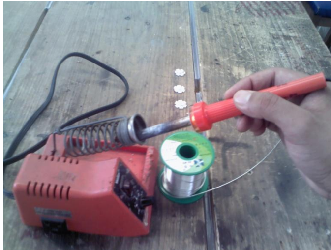
Figura 5.9 Calentamiento de cautín (Fuente: Elaboración Propia)
