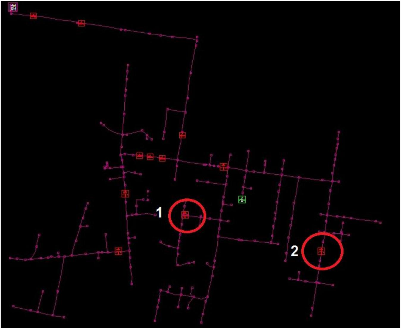
**Fig.4.2.-** Diagrama unifilar del Circuito TGU-4050 con capacitores instalados visto desde el programa SYNEERGY 4.0
