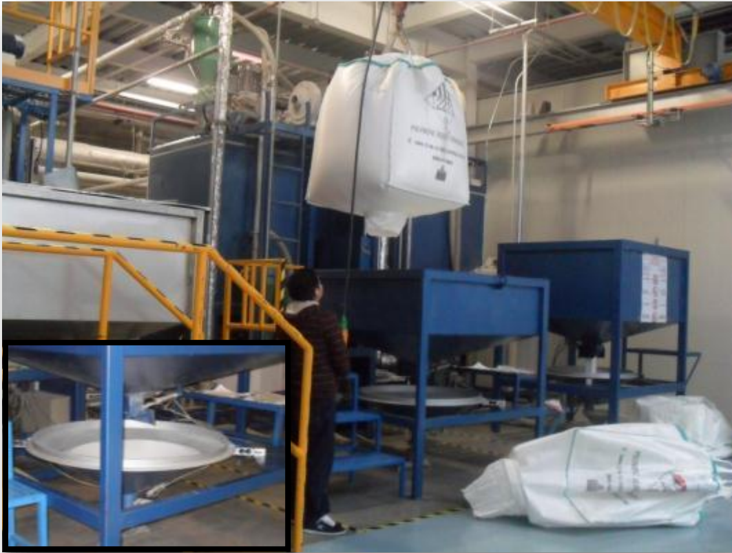
Fig. 4.26 Vaciado de la perla de EPS en la tolva de alimentación y báscula en la parte interior de la tolva de alimentación.
