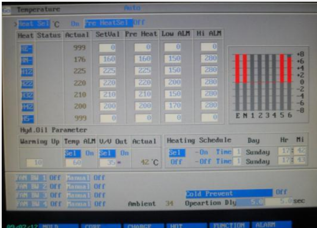
Fig. 4.18 Especificaciones de temperatura para la inyección de la pieza.
