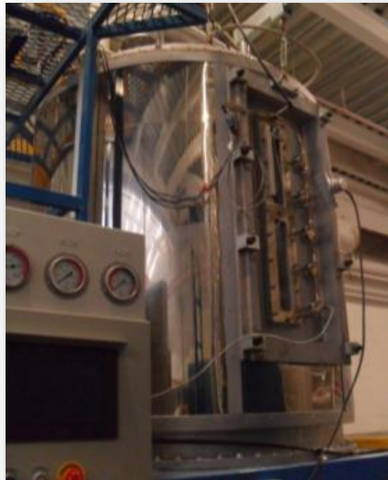
Fig. 4.27 Máquina pre-expansora donde la perla es expandida por primera vez y baja su densidad.
