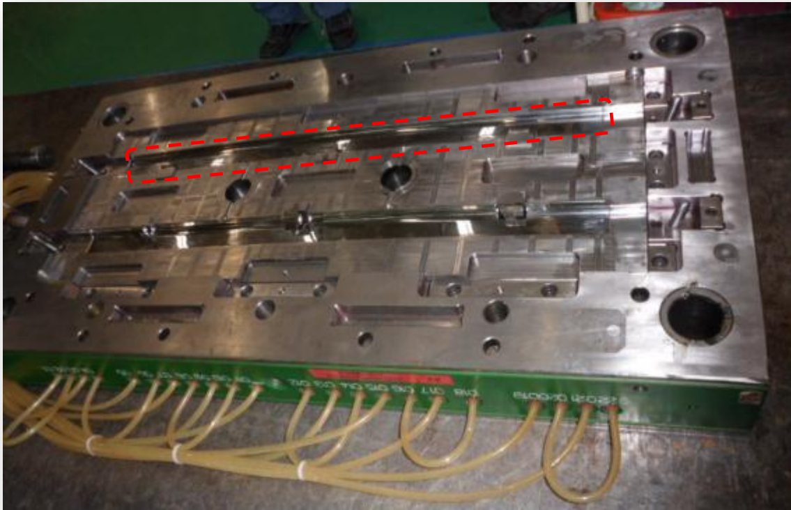
Fig. 4.23 Cavidades de un molde; físicamente es la forma que adquiere la pieza en el proceso de inyección, (señalado por medio de la línea punteada en color rojo).
