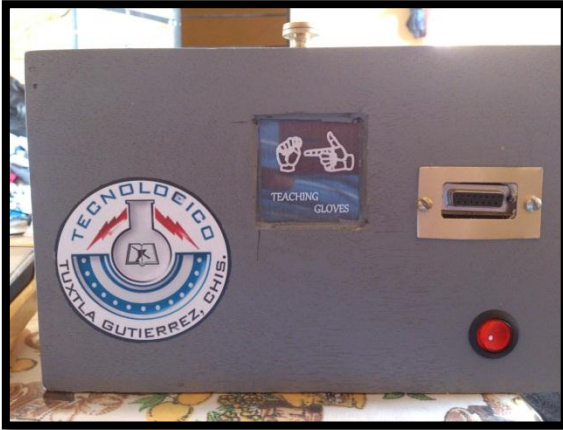
Figura 34. Vista frontal (conexión del guante y botón de encendido)
