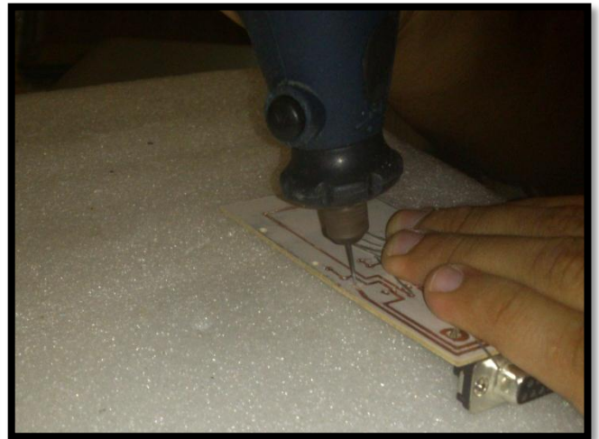
Figura 40. Perforación de la placa
