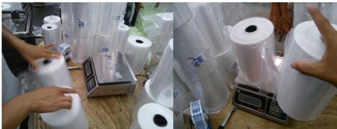
Imagen 5.8 Pesado de rollo y colocación de etiqueta
