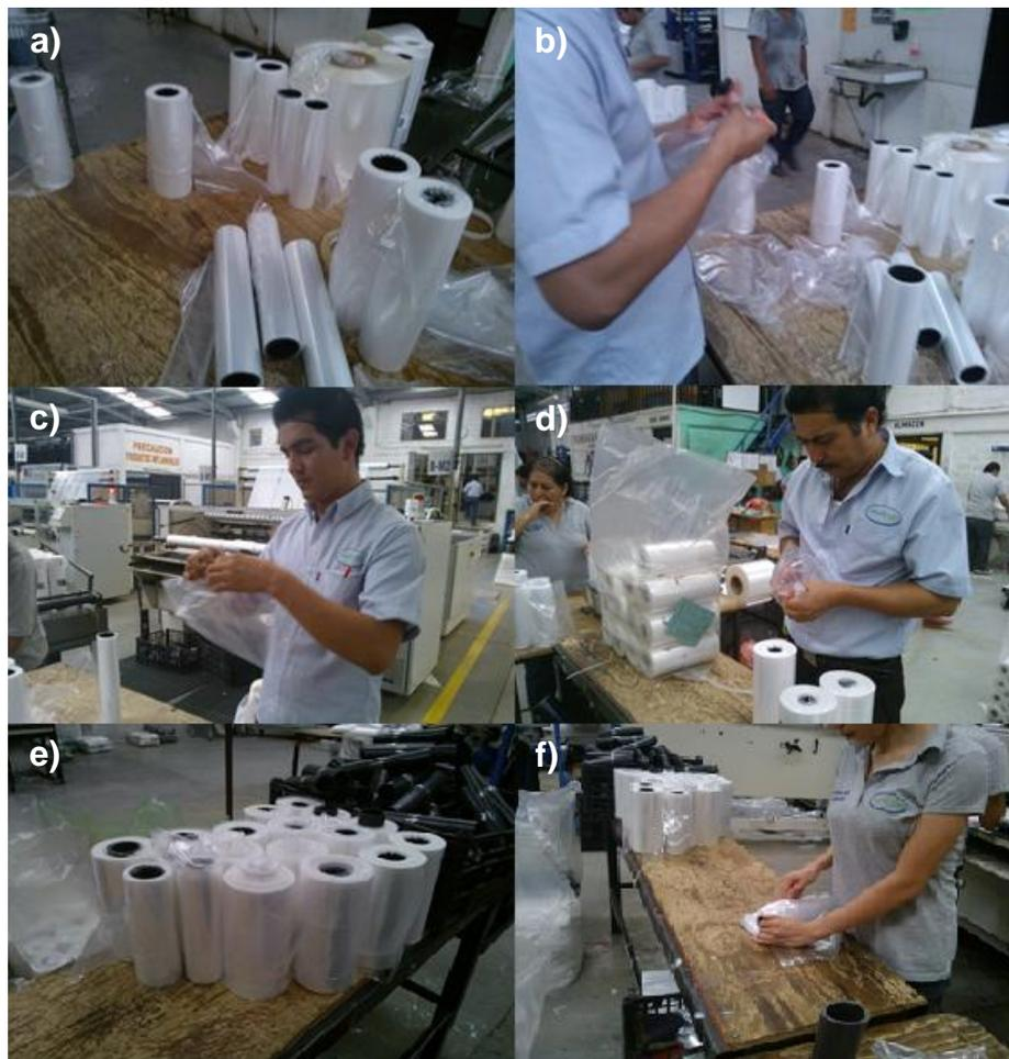
Imagen 5.9 a) Ciclo de prueba; b) y c) inspección de sellos laterales; d) inspección de resistencia; e) rollos defectuosos; f) destrucción de rollos
