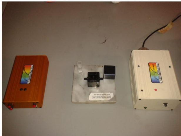
Fig. 3.3 Componentes que integran el Espectrómetro, Lámpara de luz blanca (izq.), porta muestras (centro) y espectrómetro (der.).
