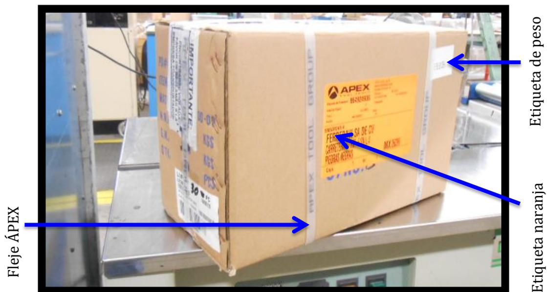
Imagen 4.6 Caja pesada, flejada y etiquetada. Fuente: Ápex Tool Group.
