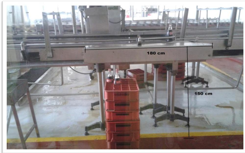
**Fig. 5.44 Medidas de estación de puesto**
