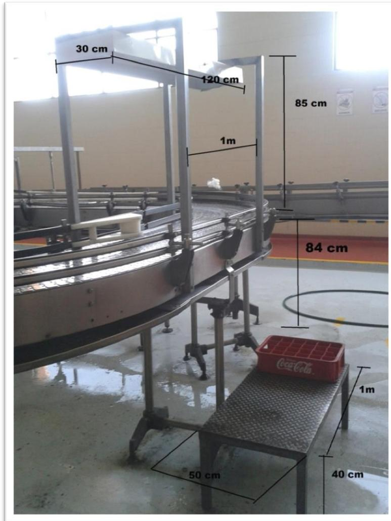
Fig. 5. 43 Medidas de lámpara y base en curva de asebi
