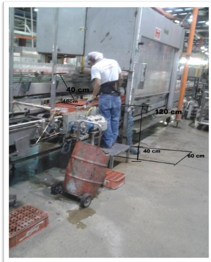
Fig., 5.32 medidas 1Mg mete plástico y retira cajas con rechazo
