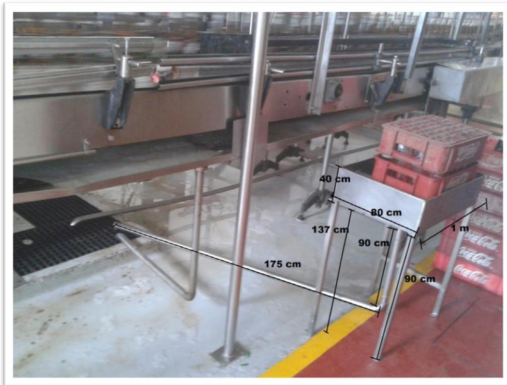
Fig.5.46 Medidas de caja de derrame de producto
