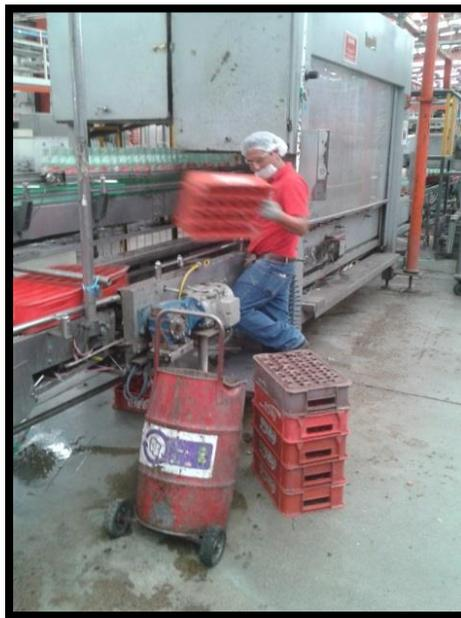
Fig. 5.12 1Mg mete plástico y retira cajas con rechazo
