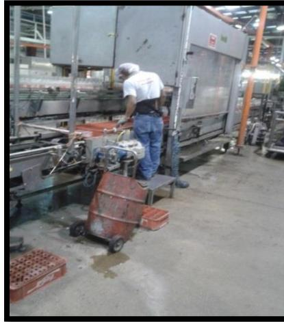
**Fig. 5.13 1Mg mete plástico y retira cajas con rechazo II**
