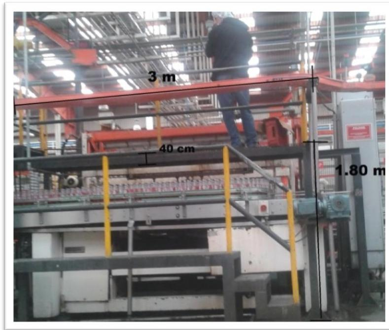
Fig. 5.51 Medidas de altura de base encajonadora
