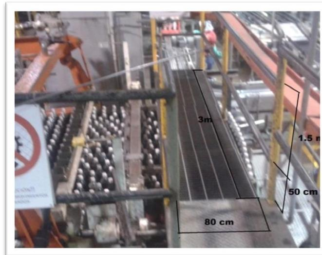
Fig. 5.49 Medidas de base encajonadora
