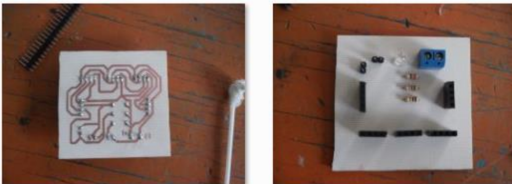
FIGURA No. 31) La placa después de colocar y soldar los componentes quedo de la forma que se ve en la imagen.
