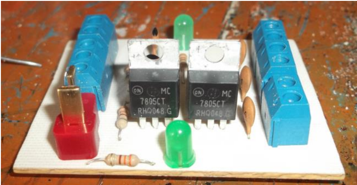
FIGURA No. 54) En esta imagen se puede observar la placa de alimentación del sistema terminada, donde se pueden apreciar dos reguladores 7805, la entrada de la batería Li-PO, las borneras de salidas, y los leds indicadores.
