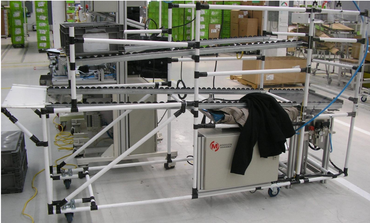
Figura 3.15. Acumulador de Producto Terminado
