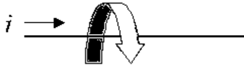
Figura 2.1. Corriente que circula a través de un hilo conductor
