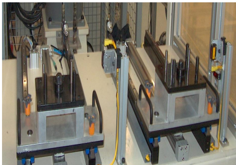
Figura 4.28. Sensores Ópticos puestos en los herramentales
