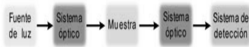
Figura 2.10. Diagrama básico de un sensor óptico
