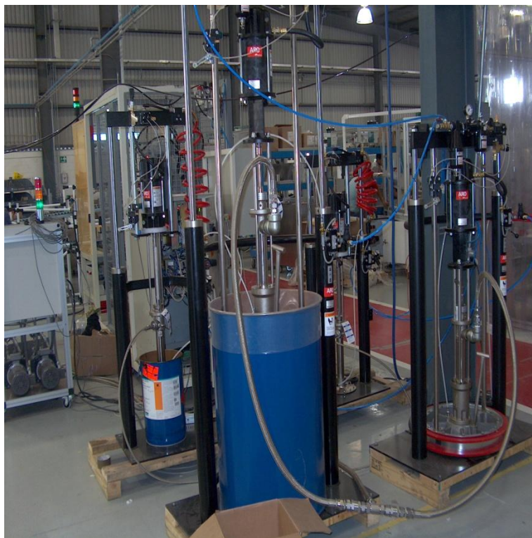
Figura 4.4. Dispensador de pegamento con líquido negro y blanco
