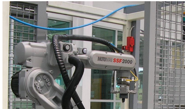
Figura 3.10. Interlock de Seguridad de la Jaula del Robot Motoman
