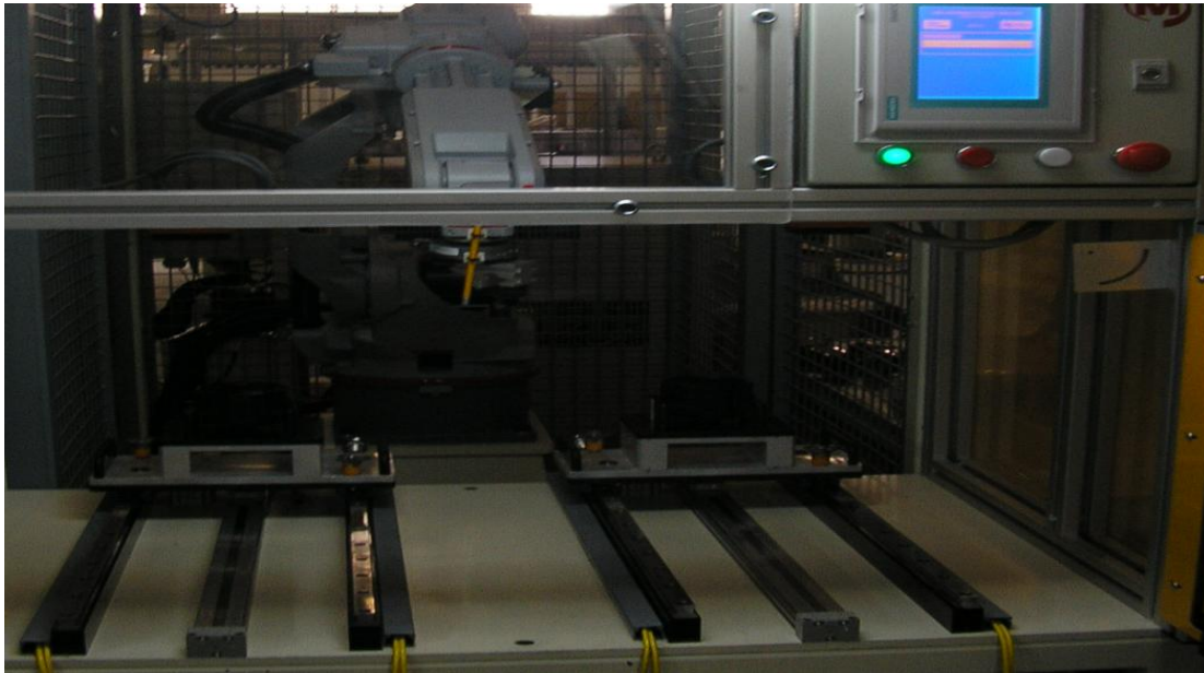
Figura 4.29. Rieles de movimientos de los herramientales
