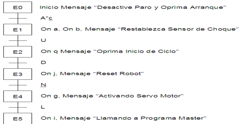
Figura 4.44. Figura del grafcet de inicialización
