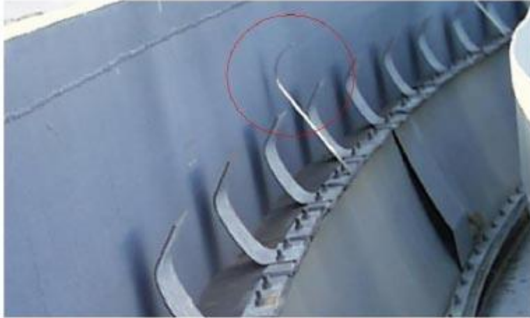
Fig. 3.11 Separación del Sistema Shunt.
