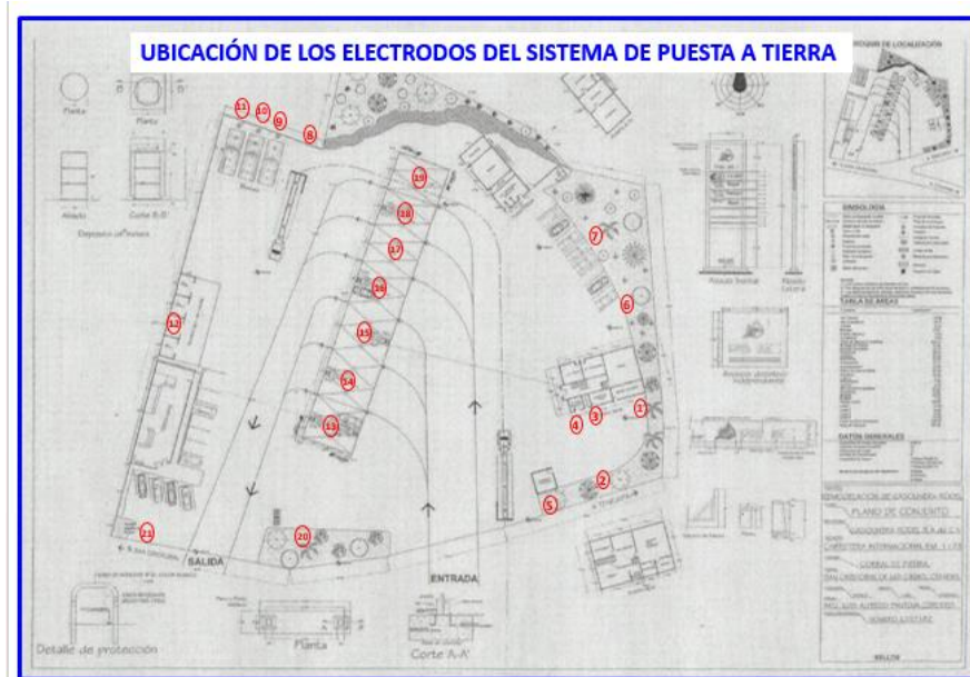
Fig. 3.3 Ubicación de los electrodos de la Gasolinera Rodel S.A de C.V
